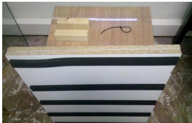
**Figura 4.56: Base mesa test setup: detalle elastómeros**
