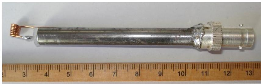
**Figura 4.13: Sonda 6: Multiespira (8 espiras) cobre esmaltado 0,6 mm según [Pee'07]**
