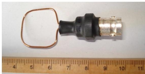
**Figura 4.9: Sonda 2: Monoespira cobre esmaltado 0.8 mm según [Smi'99]**
