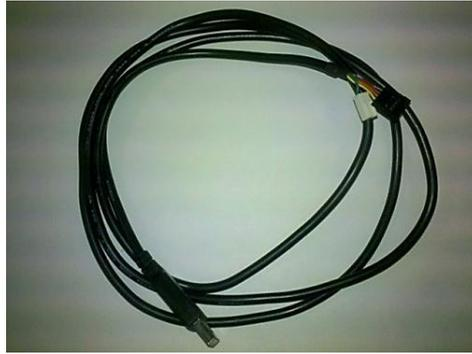
**Figura 4.42: Cable TTL-232R para la señal de encriptación**
